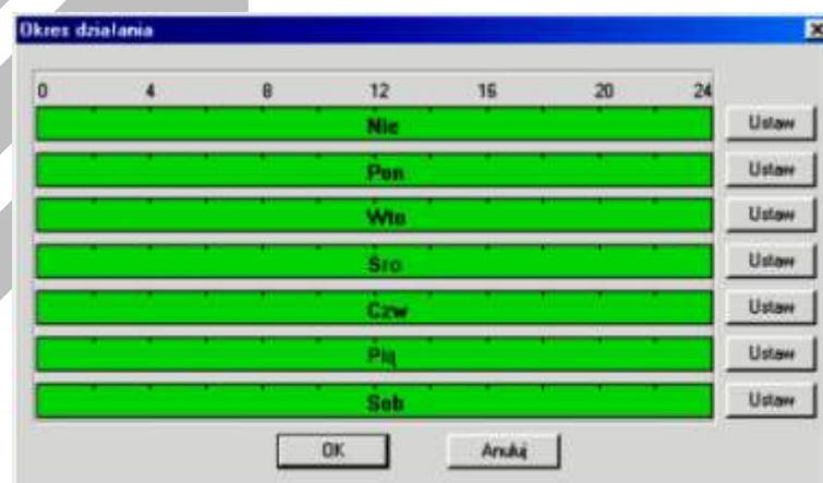
Rys. 7-38a. Ustawianie okresu aktywności wejścia alarmowego.
